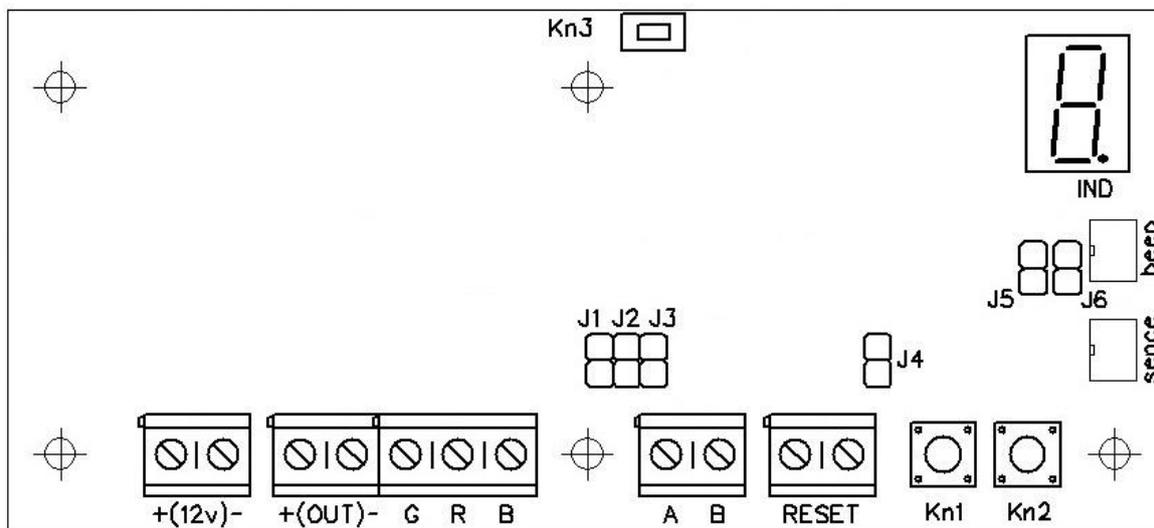
Рисунок 7.2. Внешний вид платы 3-х канального радиоприемника MP-821W4
