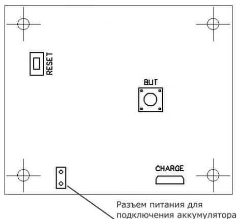
Рисунок 7.1. Внешний вид платы радиокнопки вызова MP-413W14
