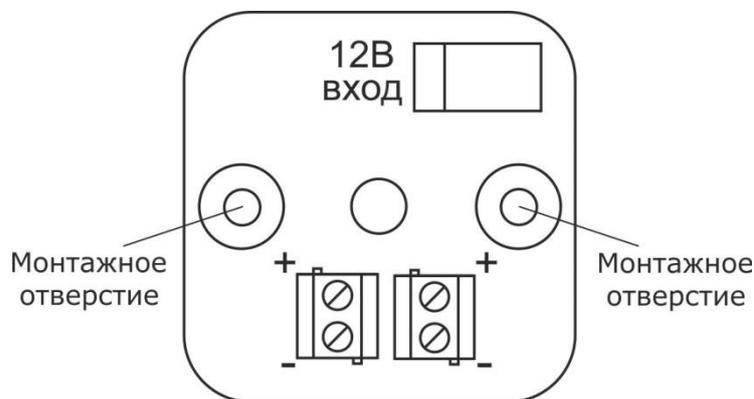
Рисунок 7.3. Внешний вид платы адаптера-блока защиты GC-0012U3
