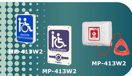
Радиокнопки вызова MP-413W11, MP-413W13, MP-413W14 и радиокнопки вызова со шнуром MP-413W2 предназначены для отправки сигнала вызова помощи. Кнопки устанавливаются в санитарных комнатах, душевых, в зонах безопасности, на входах в здание и парковках. Подключение радиокнопок вызова осуществляется к 3-х канальному радиоприёмнику MP-821W4.
