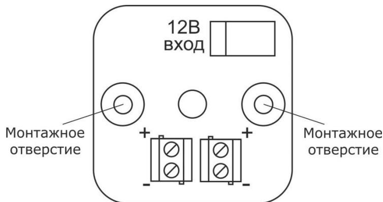
Рисунок 2. Внешний вид платы адаптера-блока защиты GC-0012U3
