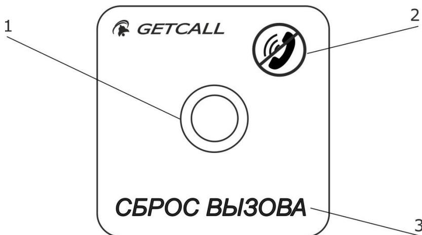
Рисунок 1. Внешний вид кнопки сброса вызова GC-0421B1
