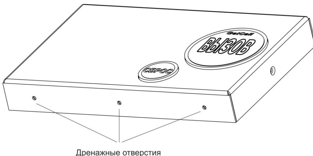
Рисунок 2. Внешний вид кнопки вызова GC-0423M1 с дренажными отверстиями
